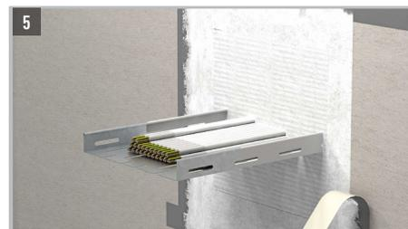
Die komplette Oberfläche innerhalb der Abklebung abschließend mit FLAMRO BML beschichten, sodass eine Trockenschichtdicke von mindestens 1 mm aufgebracht wurde.
